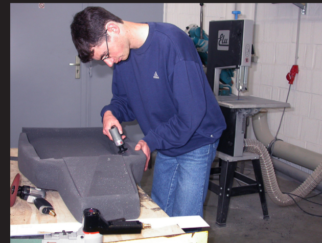
With power tools on seat foam Mit Luftschleifer am Sitzschaum
