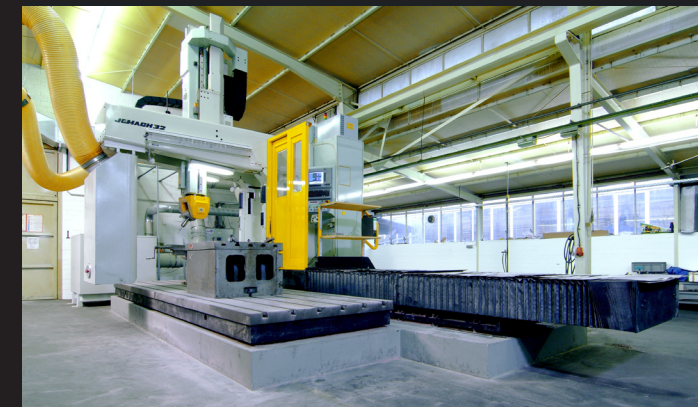
5-Axis HSC: x = 6000, y = 1780, z = 1400 5-Achsen Fräsen: Wege [mm] siehe oben
