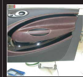
STL Rapid Prototyps; Door hard model STL Polyjet Bauteile; Modell Türverkleidung
