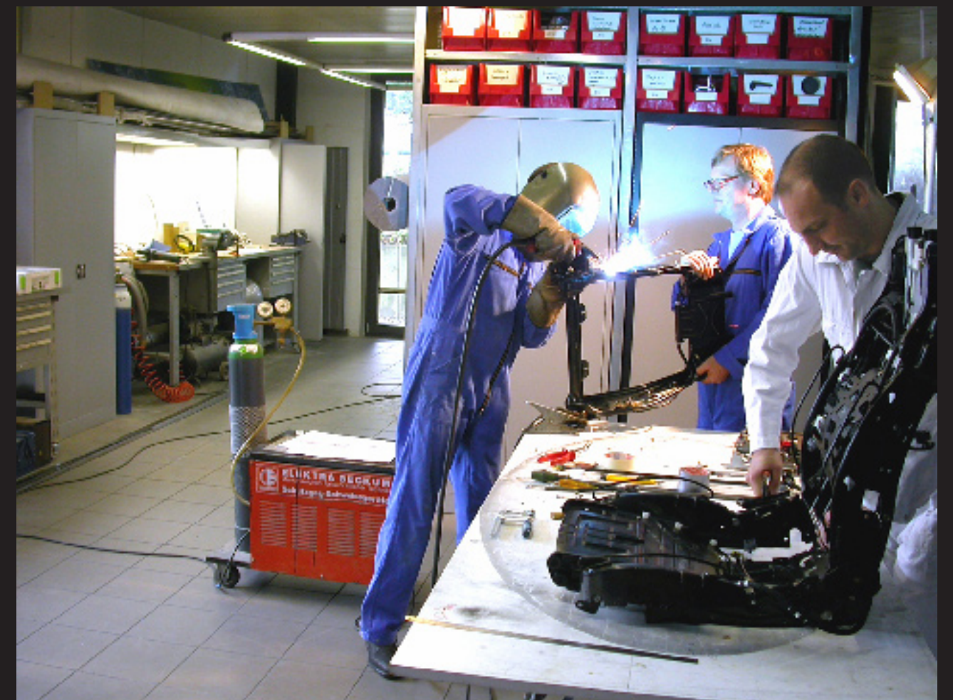
Prototyping: welding on metal seat structure Musterbau: Schweißen an der Sitzstruktur
