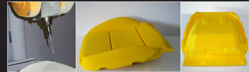
Seat PUR foam milled from CAD data Sitzschaum PUR nach Daten gefräst
